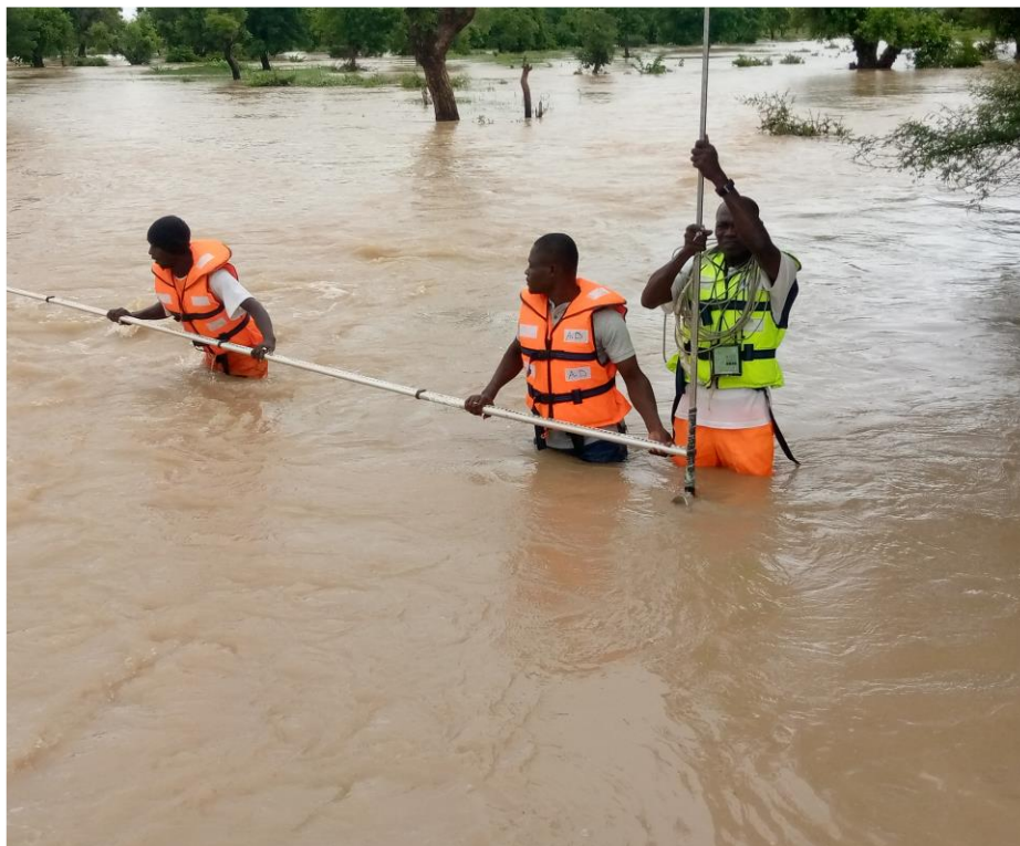
Photo 14 : Opération de jaugeage à la perche à Tollingui
